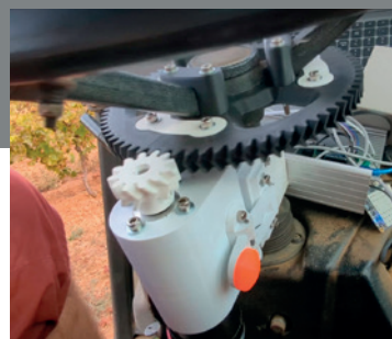
Prototype d'auto-guidage monté sur tracteur
