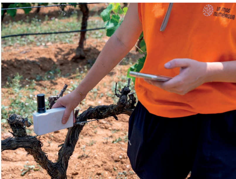
Relevé de pieds improductifs par arpentage (Rover RTK)
